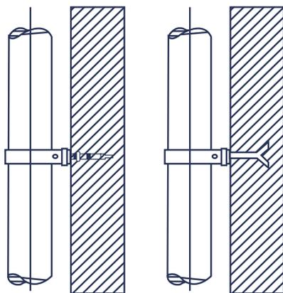
**Abrazadera Corrediza:** Se utiliza después de un cambio de dirección, seguido por un tramo largo de tubería (20 diámetros o más), permitiendo el libre deslizamiento de la tubería.
