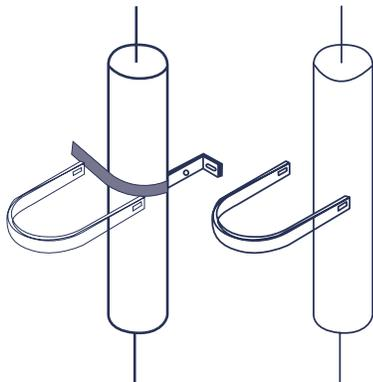
Nota: Ambas abrazaderas tanto la fija como la corrediza, pueden asegurarse a los techos o paredes por medio de tornillos de acero o ganchos de platina metálica.
