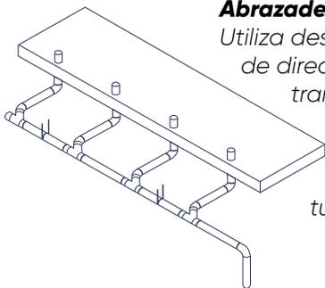
Es importante resaltar que la Norma Sanitaria vigente establece que la máxima separación entre soportes para tuberías colgantes para aguas servidas o aguas de lluvia es de 1.5 metros independientemente del diámetro.
